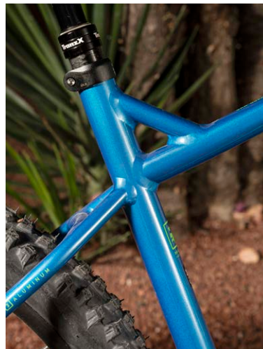
➤ Marin kasutab traditsioonilist, otse keskjooksu kohale paigutatud sadulatori, mida pole ilustatud ega plastiga kaetud.
