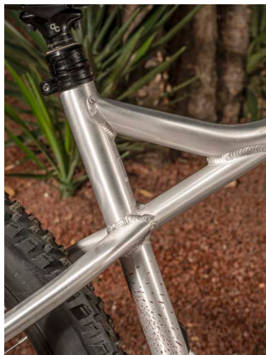
➤ Orbea raamis on rõhutoru painutatud sadulatori ülemise otsani ja selle alla on lisatud tugevdustoru - sagedamini võib kohata vastupidist lahendust.
