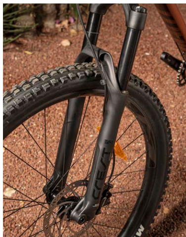
➤ Crest kahvel on jalgrattavalmistaja Gianti oma toode ja kasutab 34 mm pikkuseid liugtorusid.
